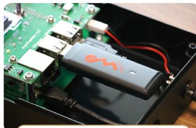
SOIT LA CLÉ MODEM POUR UNE CONNEXION VIA RÉSEAU 3G.
