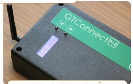
UNE FOIS LA CONNEXION ÉTABLIE (ENVIRON 1 MINUTE), LE MESSAGE « SYSTEM OK » APPARAÎT : LE DISPOSITIF EST PRÊT À ÊTRE UTILISÉ.
