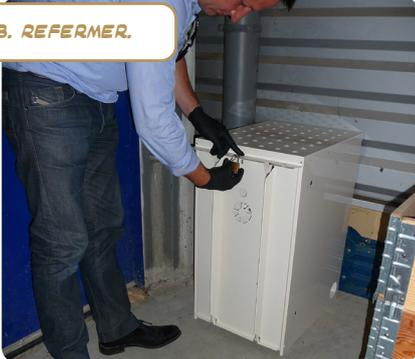
14. QUAND LES RONGEURS AURONT PRIS L'HABITUDE DE VENIR CONSOMMER (MANGEOIRE QUASI-VIDE), L'APPLICATEUR ACTIONNERA LE PIÈGE EN METTANT SUR ON POUR PERMETTRE LES CAPTURES. DÈS QU'UN RONGEUR VIENDRA, LE SENSEUR ACTIONNERA LE SOL DE LA PASSE-RELLE POUR LE FAIRE BASCULER DANS LE PRODUIT CONSERVANT. CE POSTE VA POUVOIR ÊTRE CONNECTÉ ET L'APPLICATEUR RECEVRA L'INFORMATION SUR SON SMARTPHONE.
