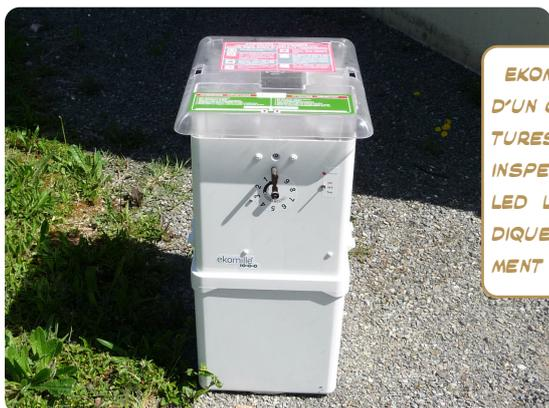
EKOMILLE EST DOTÉ D'UN COMPTEUR DE CAPTURES QUI FACILITE LES INSPECTIONS ET D'UNE LED LUMINEUSE QUI INDIQUE LE FONCTIONNEMENT DE L'APPAREIL.
