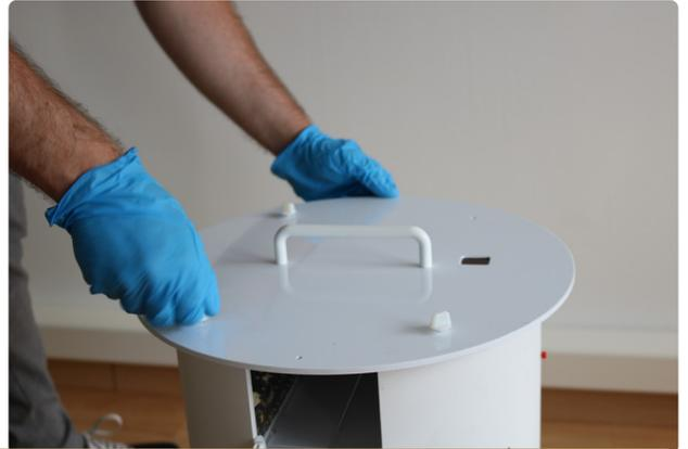
13. METTEZ LE SYSTÈME HORS TENSION EN POSITIONNANT L'INTERRUPTEUR SUR OFF. PATIENTEZ QUELQUES SECONDES ET REPOSITIONNEZ L'INTERRUPTEUR SUR ON. REPOSITIONNER LE COUVERCLE DU CYLINDRE ET BIEN VISSER LES 4 BOULONS PAPILLON.
