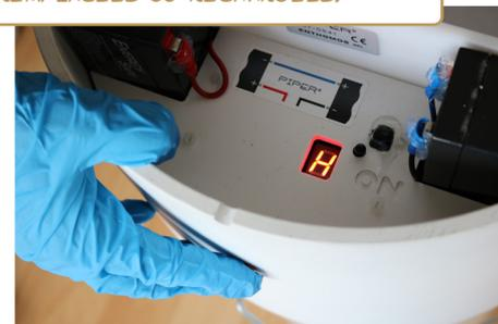
9. APPUYEZ PENDANT ENVIRON 3 SECONDES SUR LE BOUTON ROUGE D'ACTIVATION DE L'ÉCRAN QUI SE TROUVE SUR LE CÔTÉ DU CYLINDRE, PUIS RELÂCHEZ-LE. L'ÉCRAN AFFICHE « 0 » : LE SYSTÈME EST OPÉRATIONNEL, AUCUNE CAPTURE N'A ENCORE ÉTÉ EFFECTUÉE.
