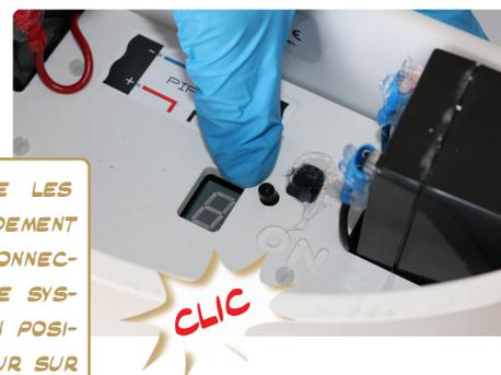
10. APPUYEZ À NOUVEAU SUR LE BOUTON ROUGE JUSQU'À CE QUE L'ÉCRAN AFFICHE LA LETTRE « H » (HIGH : LES BATTERIES SONT CHARGÉES). SI L'ÉCRAN AFFICHE LA LETTRE « L » (LOW) EN SUIVANT CETTE MÊME PROCÉDURE, CELA SIGNIFIE QUE LES BATTERIES SONT DÉCHARGÉES ET QU'ELLES DOIVENT ÊTRE REMPLACÉES OU RECHARGÉES.
